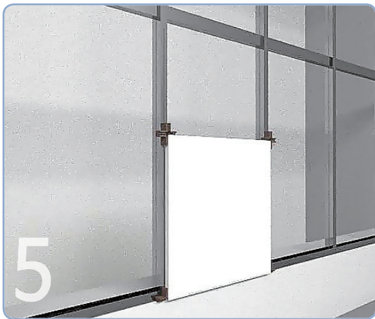
5 아연도패널을 코너간격재에 끼워 설치한다
