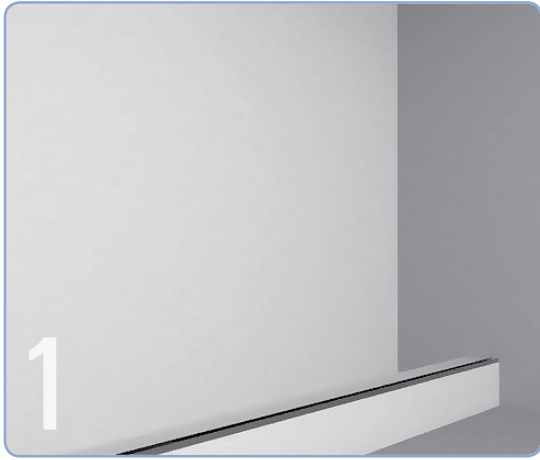
1 기준선에 따라 하부와 상부 구체면에 Runner를 설치한다
